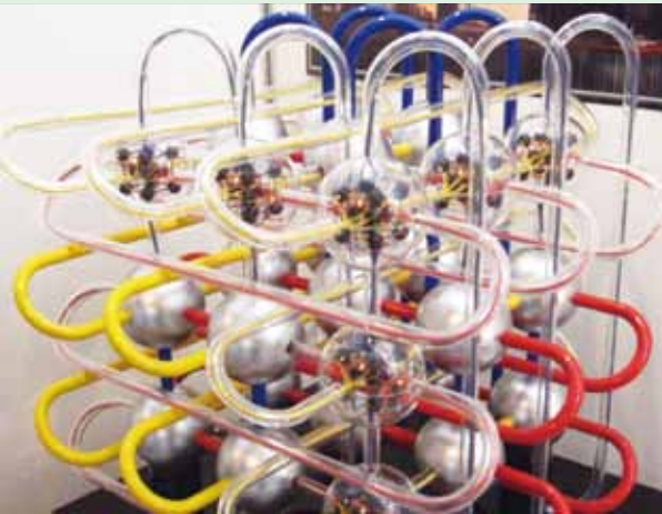
「京速コンピュータ「京」では、6次元メッシュ／トラス構造ネットワーク(Tofu)という革新的なネットワーク構成を採用。ノード間通信の時間短縮に貢献している。写真はTofuの概念模型」
